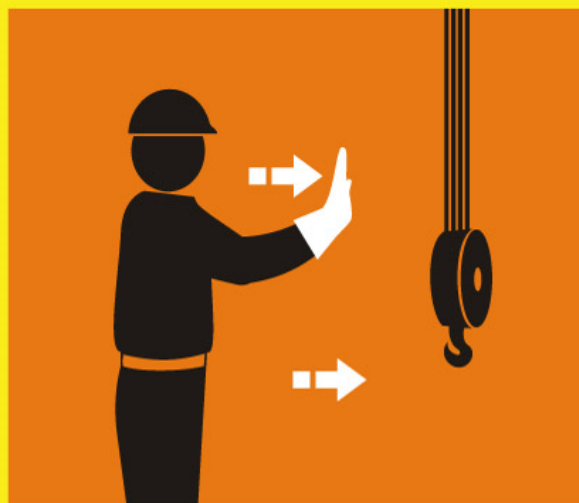
สะพานปั้นจั่นเคลื่อนที่ (BRIDGE TRAVEL)
