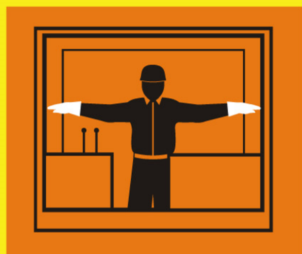
เลิกใช้ปั้นจั่น (MAGNET IS DISCONNECTED)
