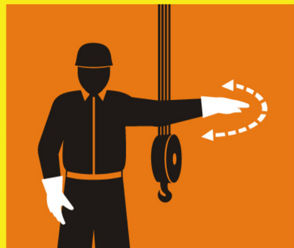
หยุดยกของฉุกเฉิน (EMERGENCY STOP)
